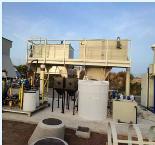
De izquierda a derecha, decantación lastrada (CLARIFAST) y flotación por aire y/o ozono disuelto (DAFAST).
